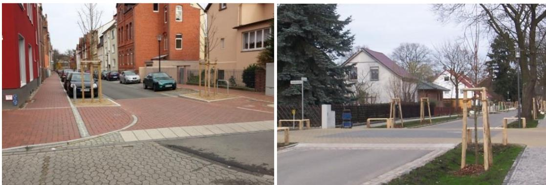
**Abb. 50** Beispiele für Gehwegüberfahrten bzw. Plateauaufpflasterungen
