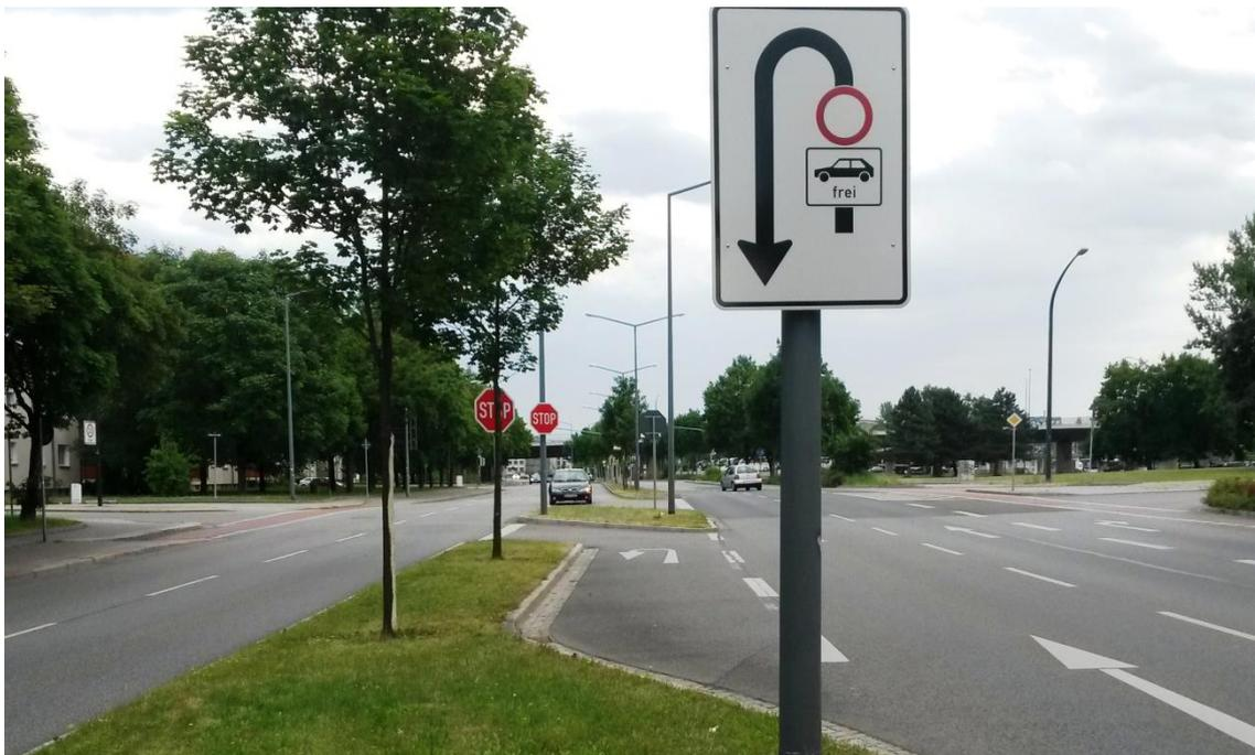
**Abb. 45** Beispiel Pkw-Wendemöglichkeit im Mittelstreifen
