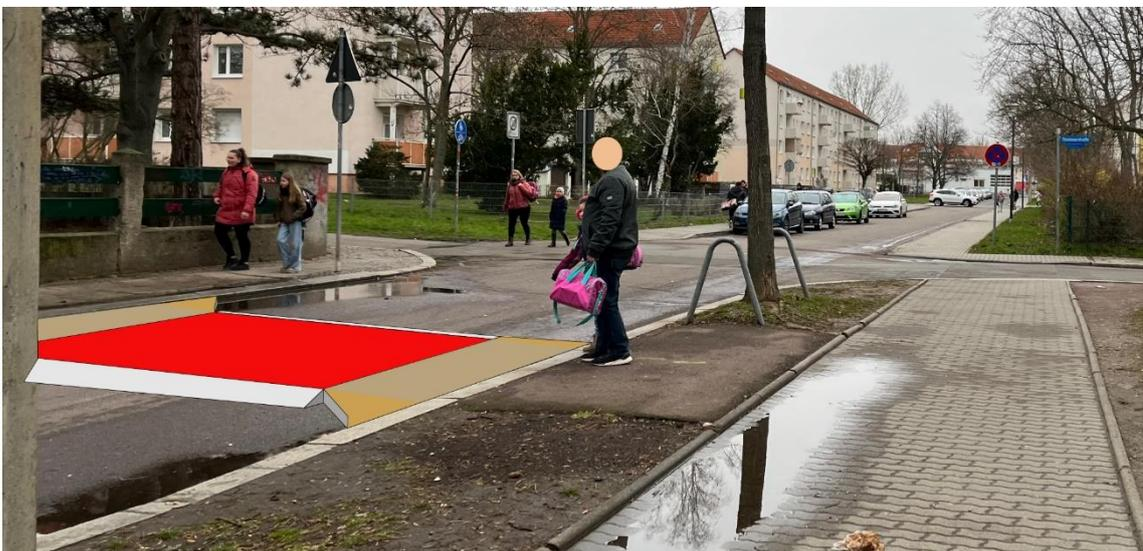
Abb. 55 Bauliche Neugestaltung der Querungsstelle als Aufpflasterung
