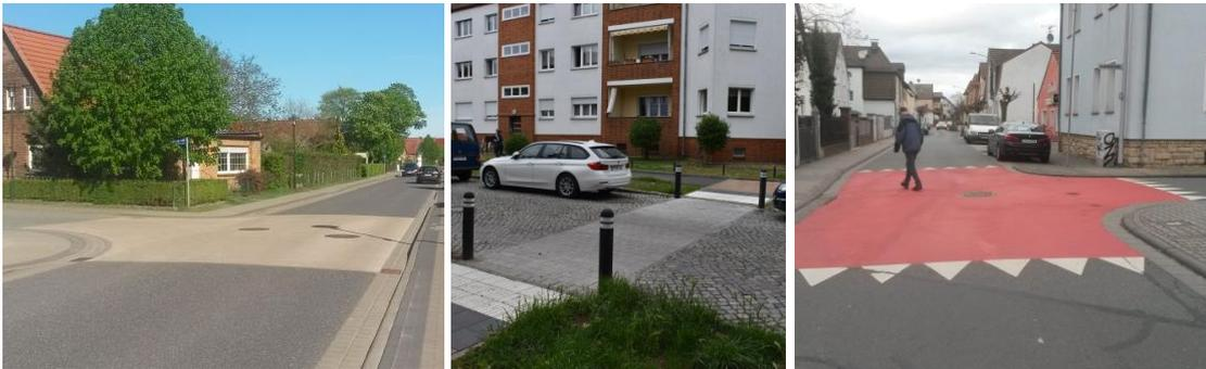
**Abb. 51** Beispiele für farbliche Einfärbung von Knotenpunkten bzw. Querungstellen
